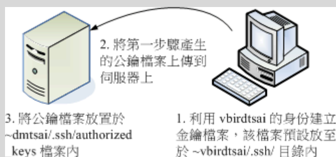
图 11.2-10、制作不需要密码的 ssh 账号基本流程
