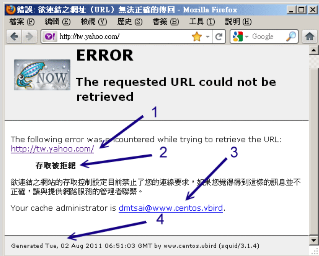
图 17.3-7、联机被 proxy 拒绝时的反应情况
