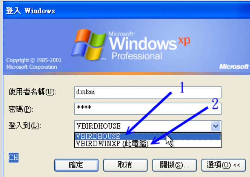
图 16.4-8、Windows 客户端连上 PDC 的方式流程示意图
