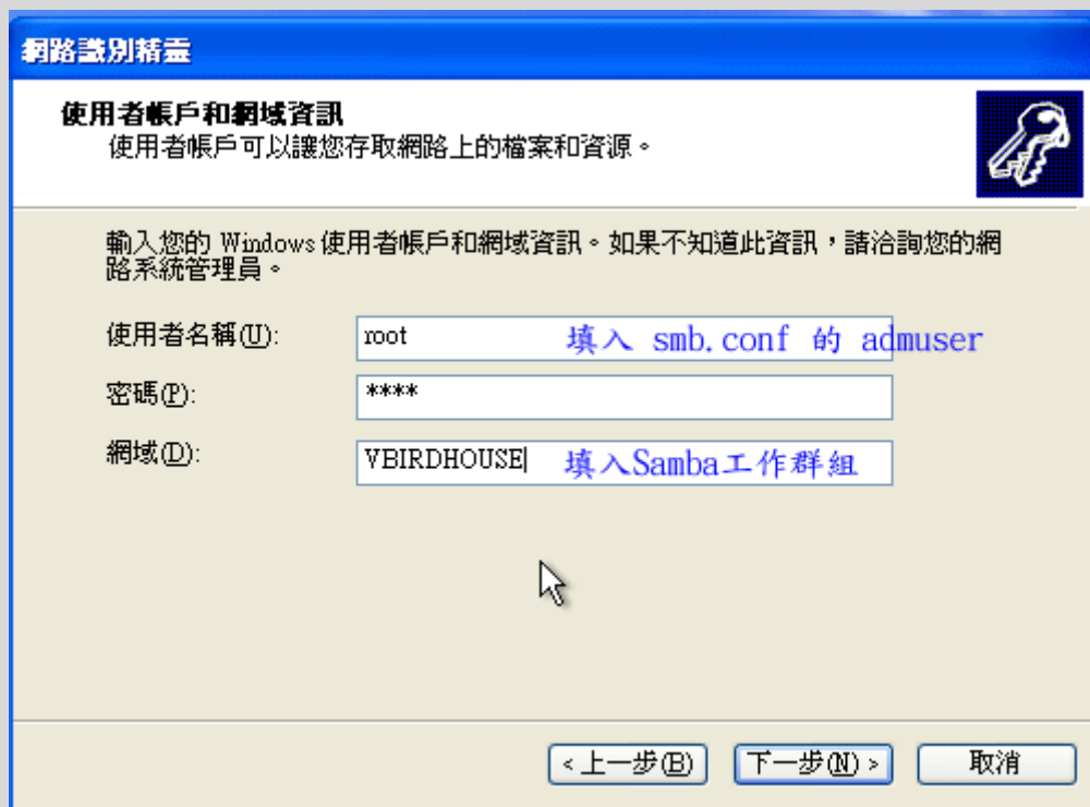
图 16.4-3、Windows 客户端连上 PDC 的方式流程示意图
